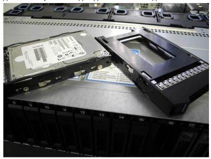
Весь конструктив креплений выполнен на защёлках, но всё смотрится очень надёжно и не должно вызывать проблем в процессе эксплуатации. Работать с компонентами сервера очень удобно, всё доступно и промаркировано.
